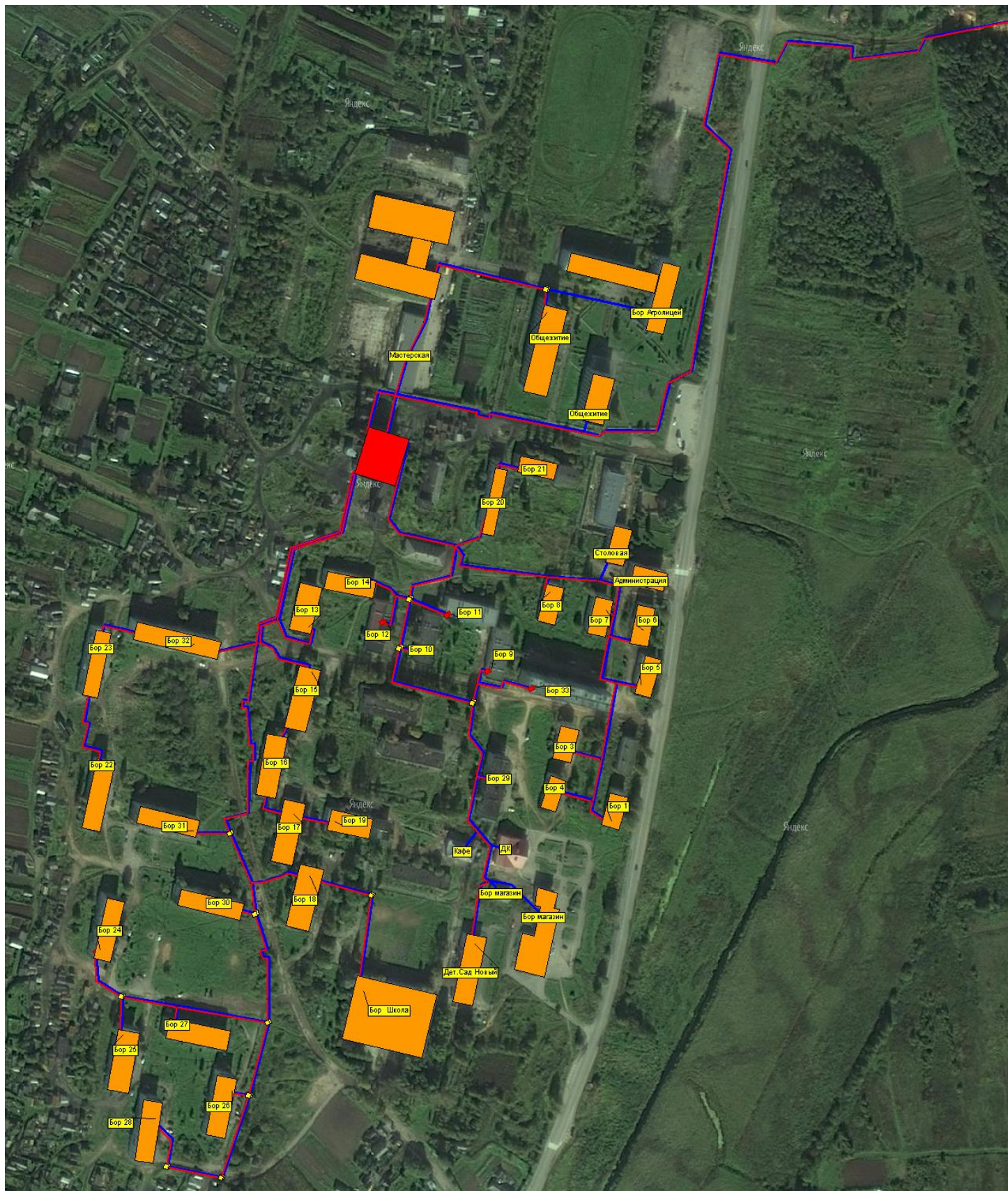
Рис2Карта-схема района реконструируемых тепловых сетей котельной д. Бор
